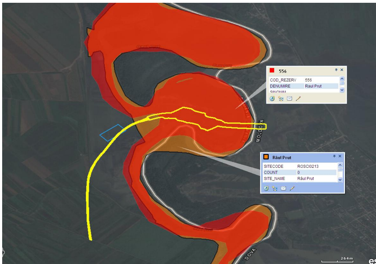
Figura 18. Amplasarea proiectului, a drumului tehnologic și a organizării de șantier in raport cu ROSCI0213 Râul Prut și RN 2.556 Râul Prut
