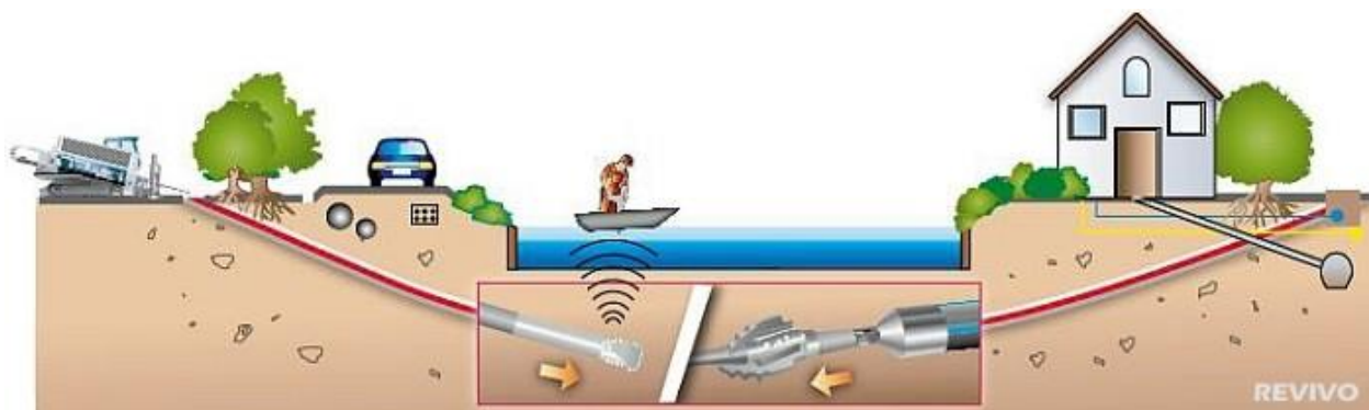
Fig.1.XII. Schema de realizare a forajelor orizontale dirijate
