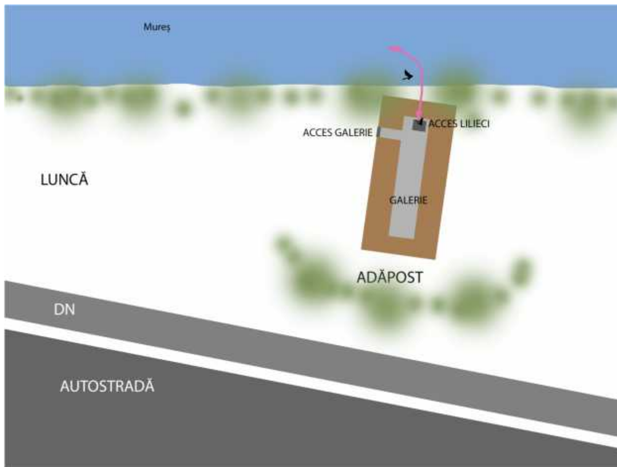
Figura 19. Schița adăpostului subteran proiectat pentru amplasare în luncă
