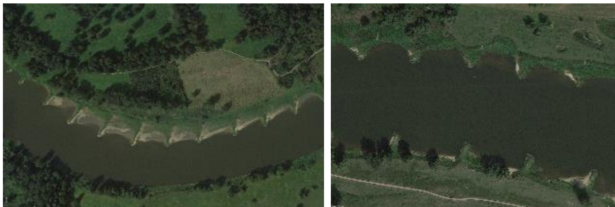
Figura 4.1-11 Cazul sedimentarii pe sectiuni ale raului Elba
