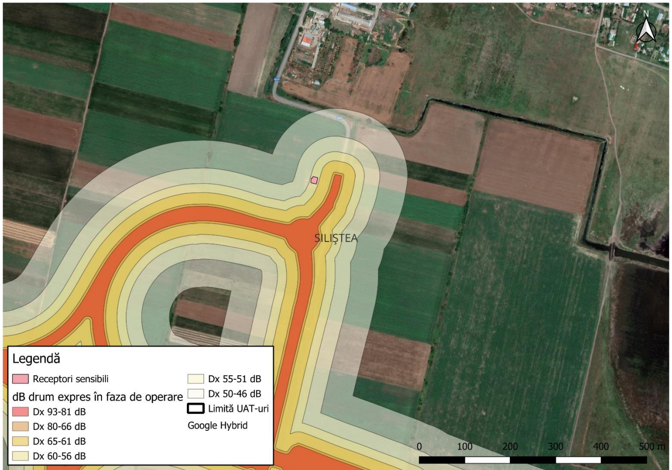
Figură 4-14. Detaliu privind existența unei construcții rezidențiale în proximitatea proiectului. Aceasta este situată la o distanță de 34 m față de breteaua de acces din zona nodului rutier Siliștea. În cazul în care se ia în considerare nivelul de zgomot aferent vitezei maxime de pe această bretea, scade la aprox. 50 dB (fără a lua în considerare traficul existent pe DJ221C).
