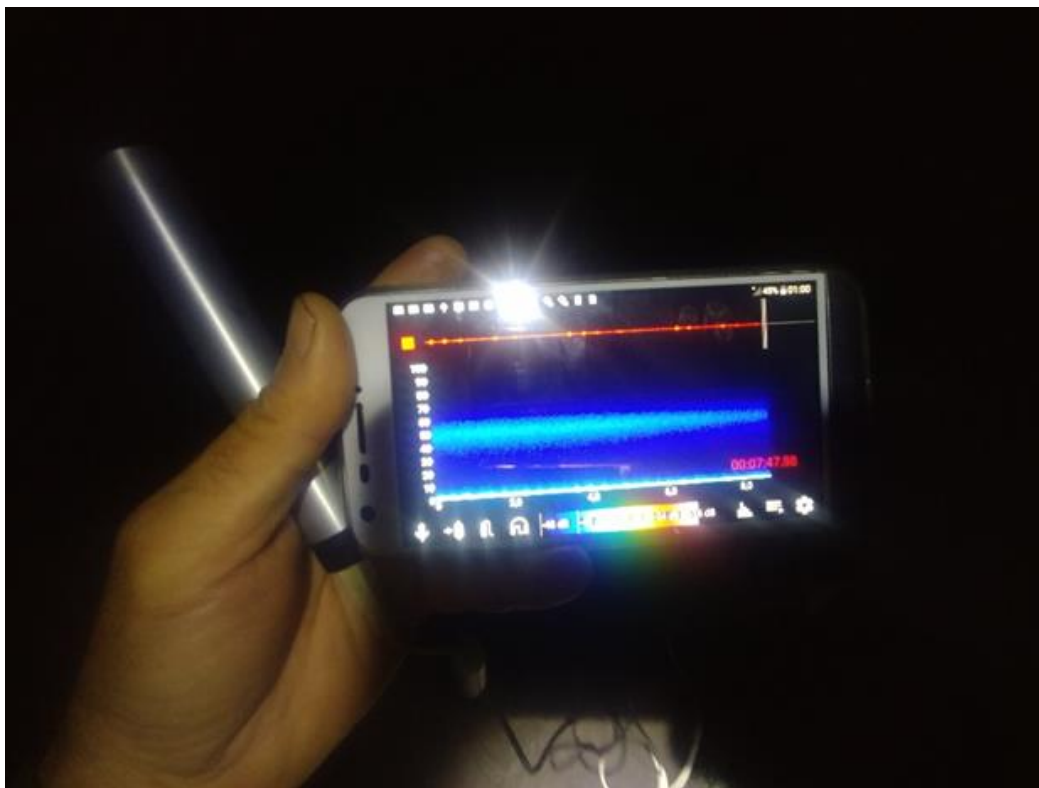
Figură 3-22. Microfon ultrasonic Dodotronic 200 conectat la telefon cu Android ce rulează programul Bat recorder
