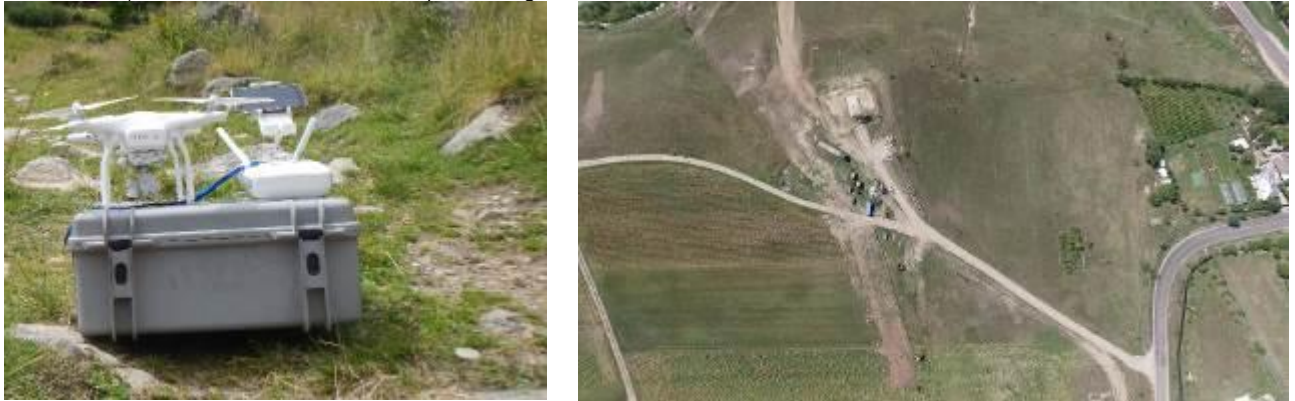
Figura 52 Drona DJI Phantom III-Advanced pregătită de zbor (stânga) și aerofotogramă (dreapta) – se observă nivelul de detaliu al aerofotogramei obținute
