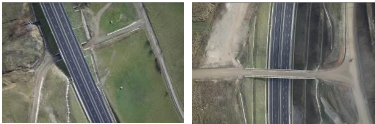
Fig.1.X.Supratraversarea unor drumuri de exploatare agricolă (stânga); subtraversarea DJ 103G (dreapta) din lungul sectorului 2B Câmpia Turzii - Gilău
