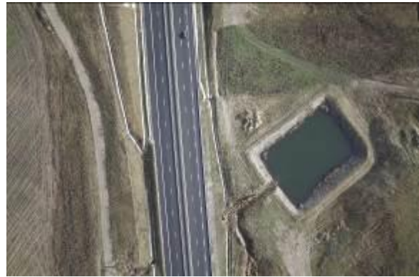
Fig.1.IX A.Decantare cu descărcare treptată dispuse în lungul sectorului 2B Câmpia Turzii - Gilău
