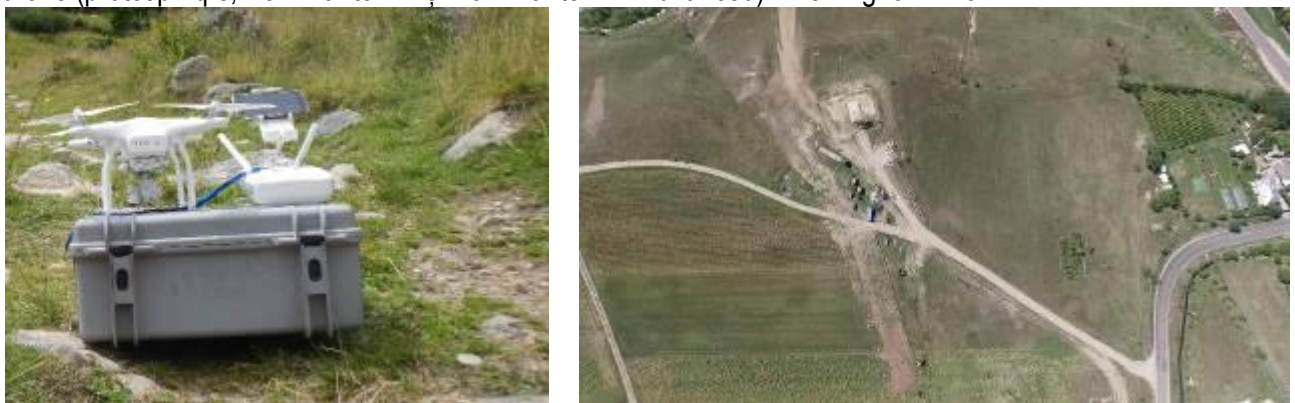
Fig.5.III. Drona DJI Phantom III-Advanced pregătită de zbor (stânga) și aerofotogramă (dreapta) – se observă nivelul de detaliu al aerofotogramei obținute
