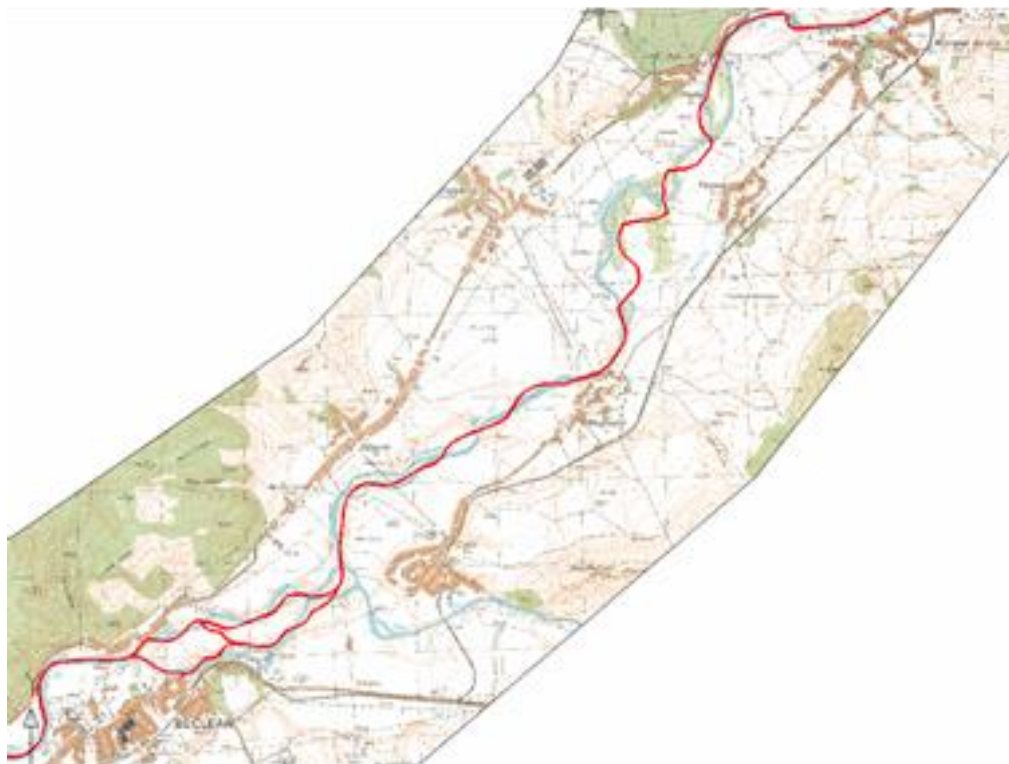
Fig. 4.1.1: Modificarea traseului în plan a albiei minore a râului Somesul Mare între anii 1984 – 2005 în zona Mogoseni-Nimigea de Jos
