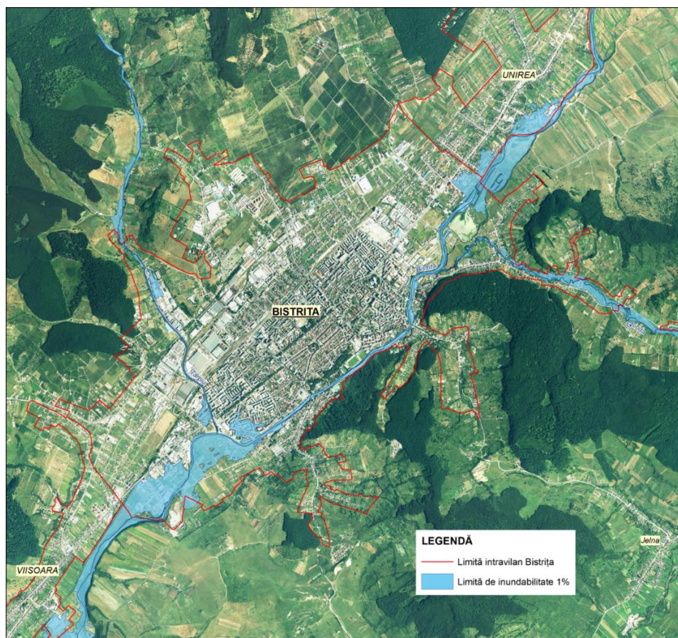
Fig.18.2.5 Pozitia suprafetei libere corespunzatoare debitului cu probabilitatea de 1% pe cursurile de apa cadastrate care traverseaza municipiul Bistrita si localitatile Unirea si Viisoara
