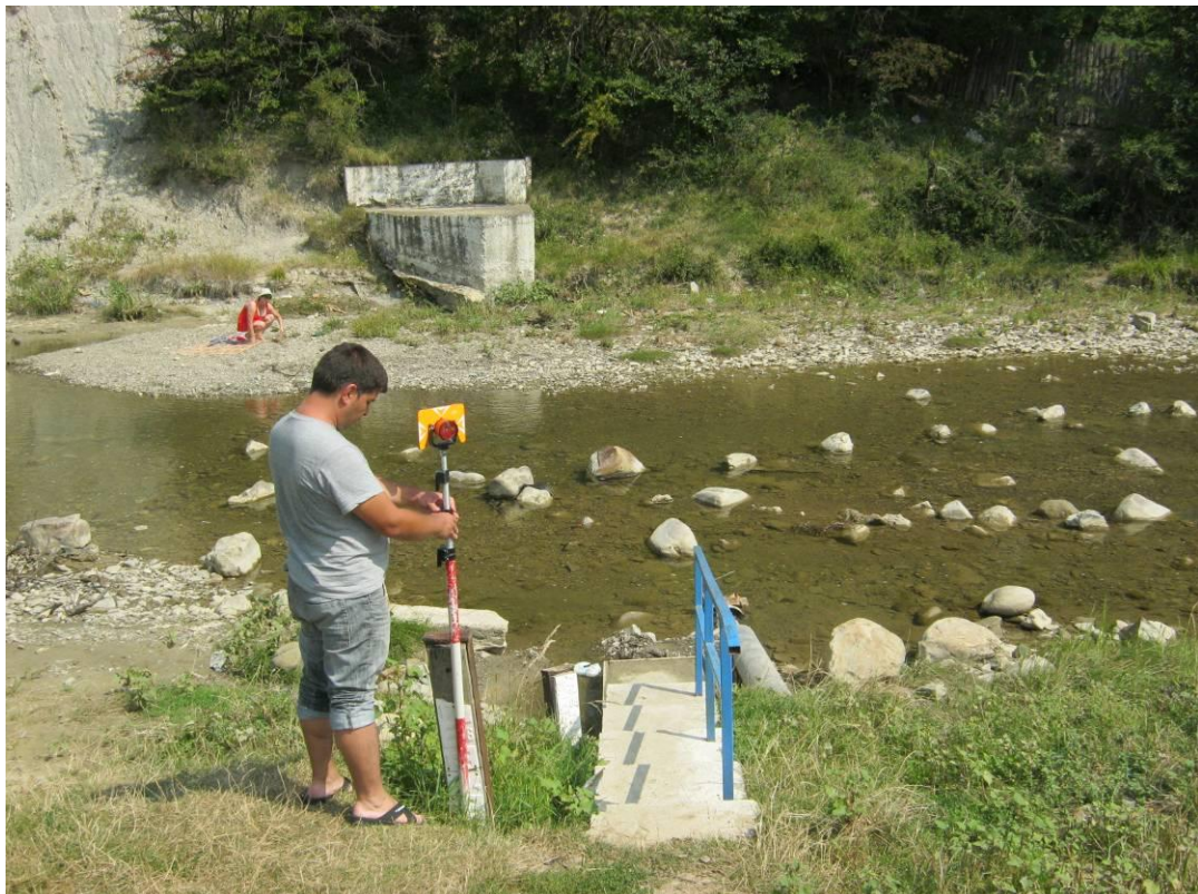
Figura 3.2-6 Măsurători topografice Stația Hidrometrică Lucăcești
