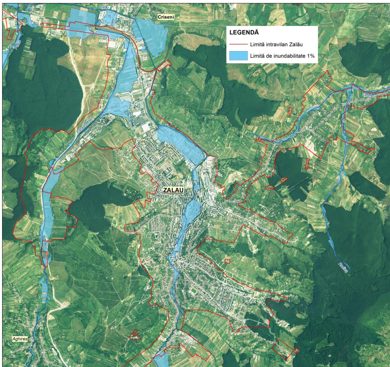
Fig.18.2.4. Poziția suprafețelor inundate în intravilanul municipiului Zalau în cazul apariției unor viituri cu debitul maxim corespunzător unei probabilități de depășire de 1%
