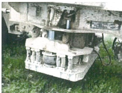
Fig. 12: Presa vehiculului Vibroseis
