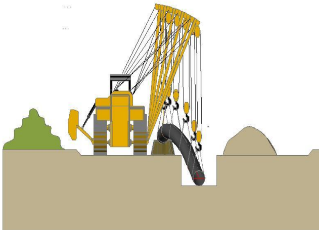
Figura 6 Etapa de lansare a conductei de transport gaze naturale schematic (stânga) și aspect de la nivelul unui șantier (dreapta)
