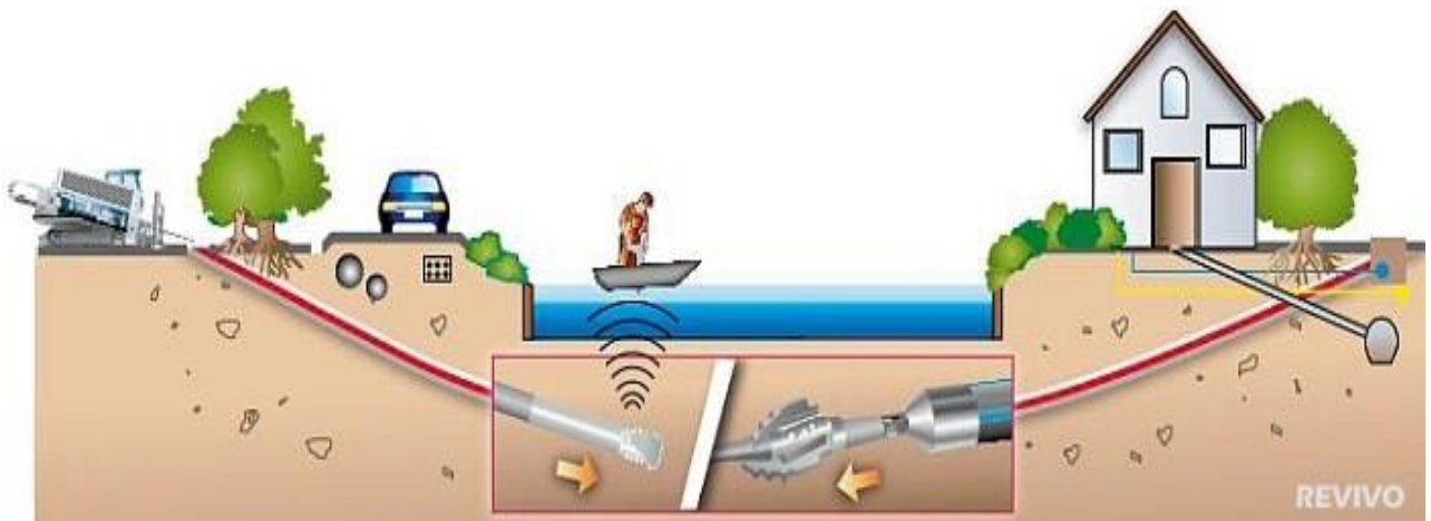
Figura 22 Schema de realizare a forajelor orizontale dirijate
