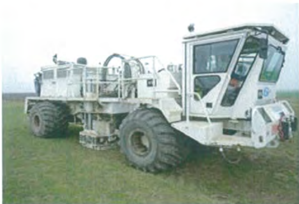
Fig. 11: Vehicul tip Vibroseis echipat cu presa centrală
