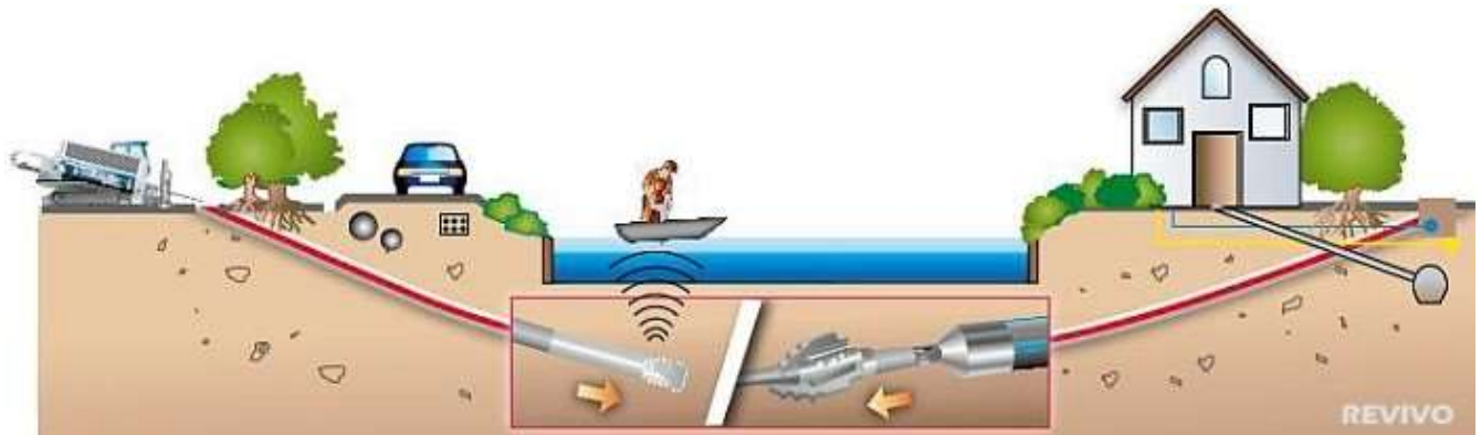
Figură 29 Schema de realizare a forajelor orizontale dirijate
