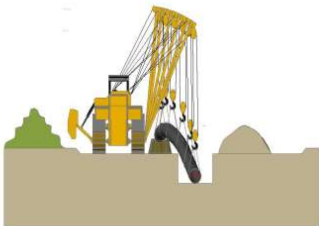
Figură 22 Etapa de lansare a conductei de transport gaze naturale schematic (stânga) și aspect de la nivelul unui șantier (dreapta)
