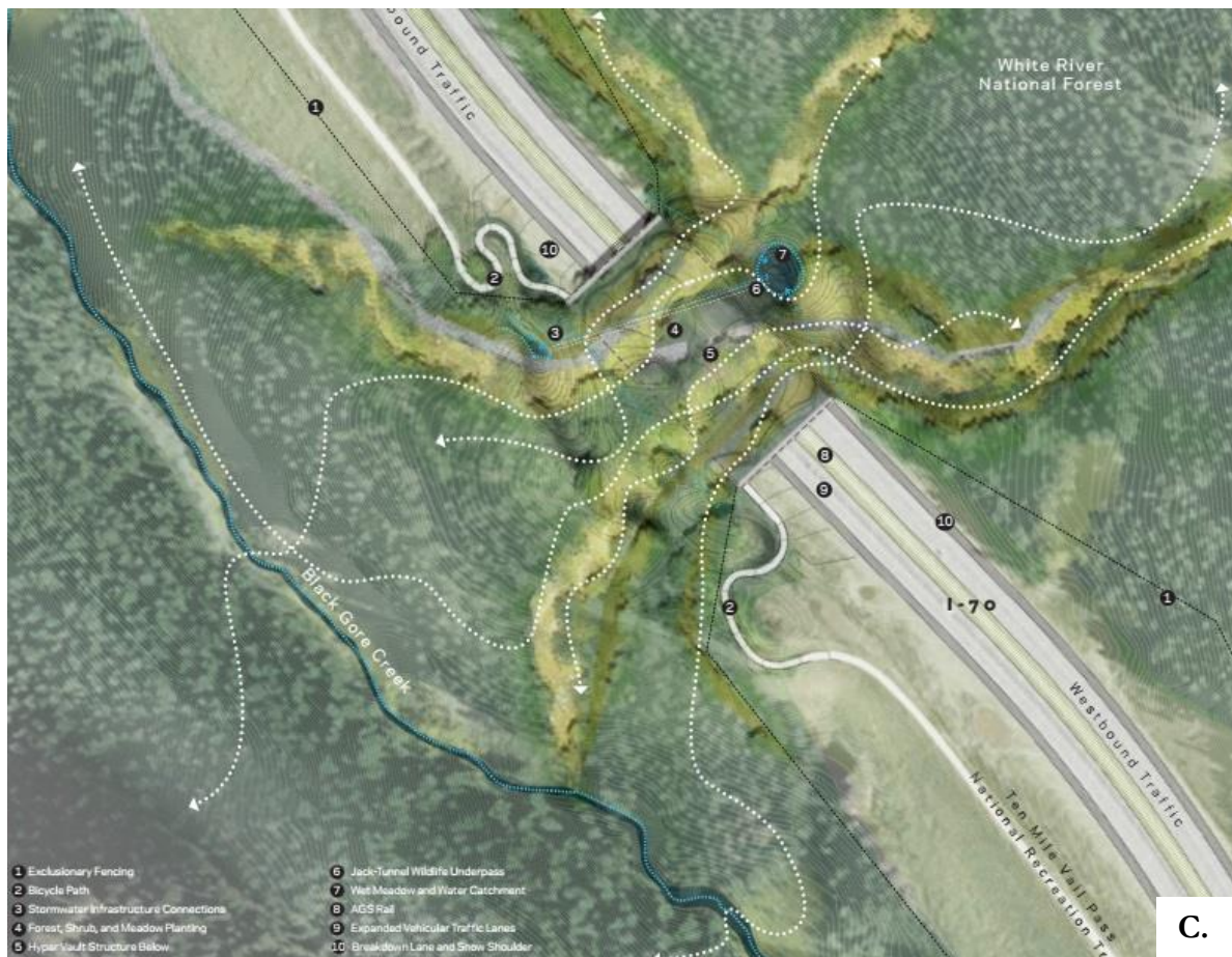
Figura nr. 5-16 A., B. Exemple ale unor ecoducte realizate în Olanda și a unui design experimental (C.) ce ia în calcul menținerea unor coridoare de deplasare ale speciilor de faună sălbatică
