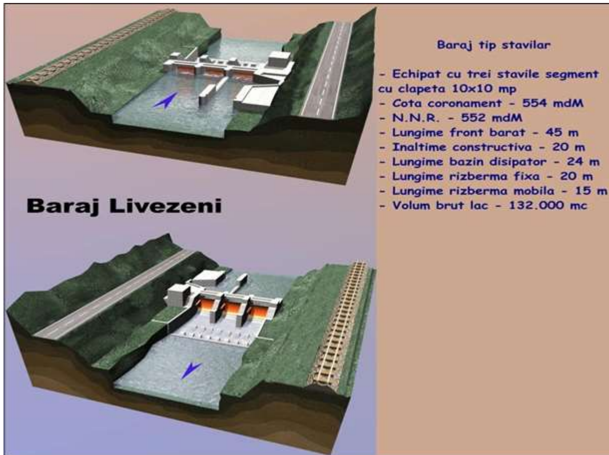
Figura III-2 Baraj Livezeni - din cadrul proiectului Amenajare hidroenergetica a raului Jiu pe sectorul Livezeni-Bumbesti. Continuare lucrari
