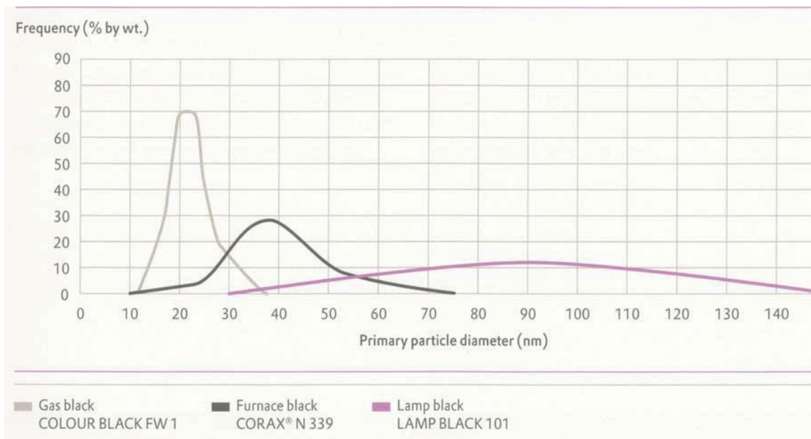
Figura 5. Diametrul particulelor primare din negrul de fum (Regulament pentru negrul de fum, 2010)
