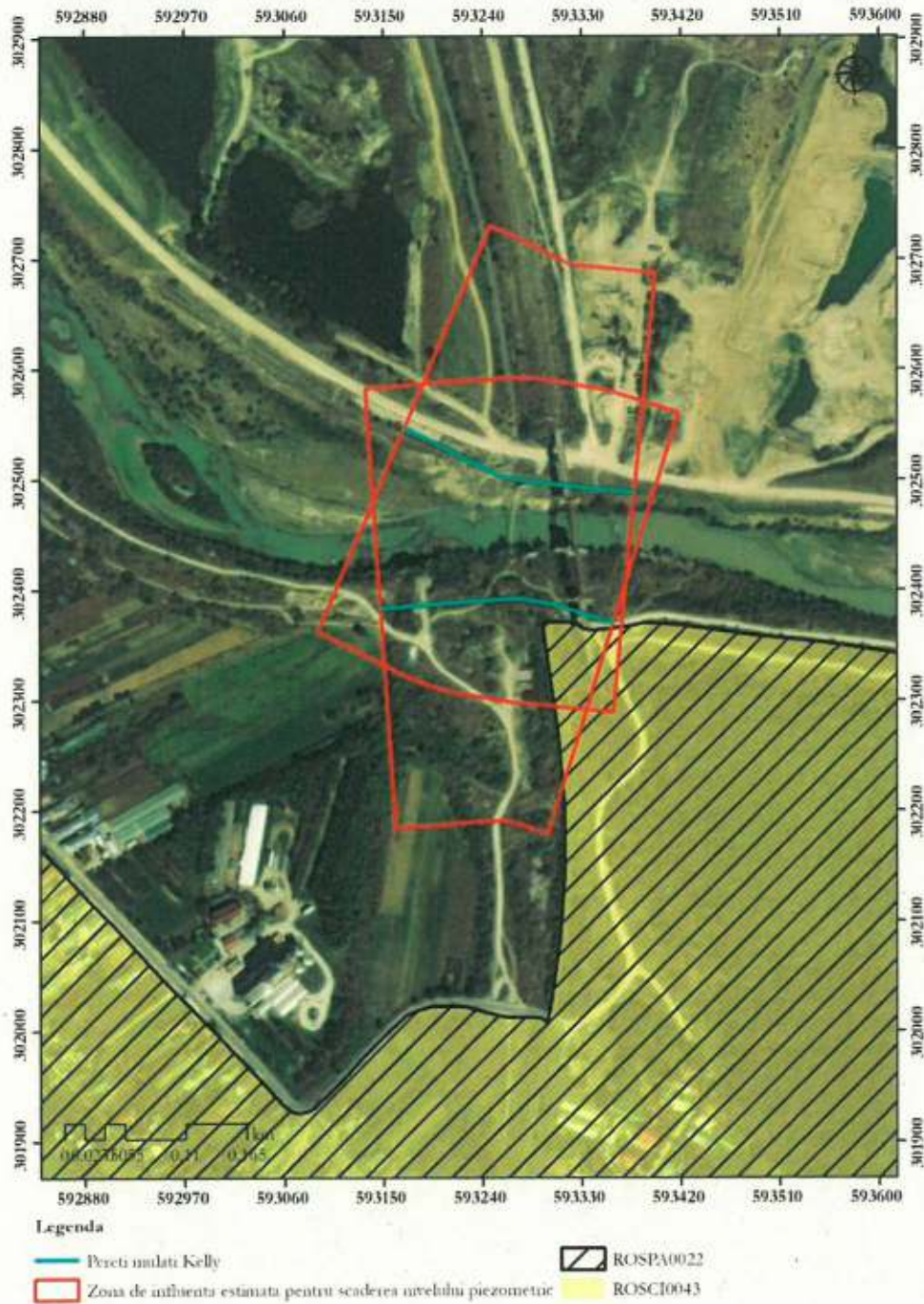
Figura nr. 7-1 Zona de influență în ceea ce privește estimarea scăderii nivelului piezometric ca urmare a realizării pereților mlați pe malurile râului Argeș
