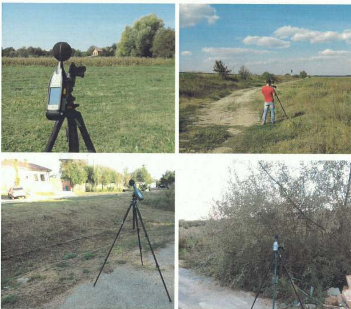
Figura nr. 2-30 Realizarea măsurătorilor de zgomot
