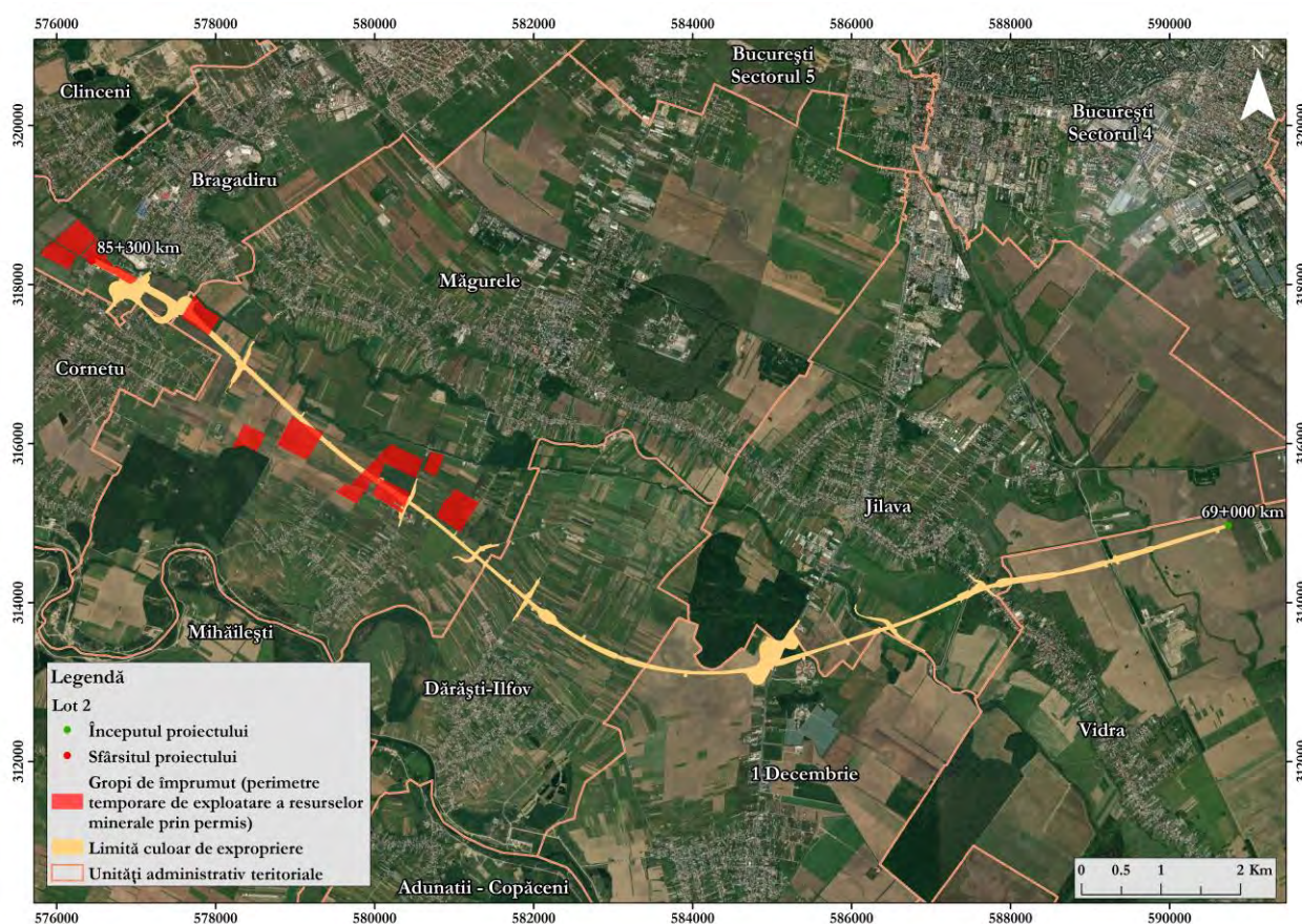
Figura nr. 6-47 Locații posibile pentru realizarea gropilor de împrumut (perimetre temporare de exploatare a resurselor minerale prin permis)
