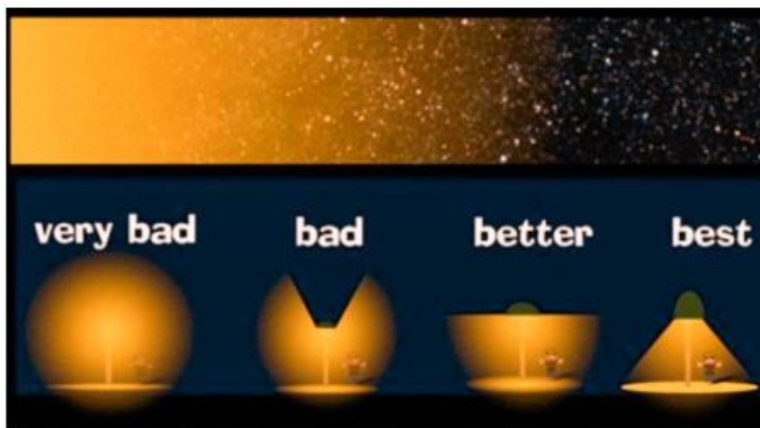
Figura nr. 7-1 Exemplu al unui sistem de iluminare adecvat pentru concentrarea dispersiei exclusiv asupra carosabilului
