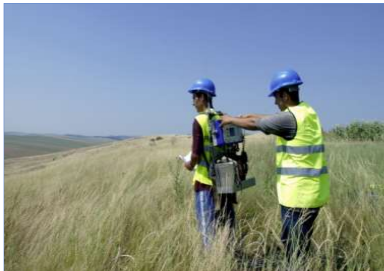
Fig. 11 Aparat folosit pentru detonarea controlata, purtat de un membru al echipei (sursa foto: HOCOR SRL)
