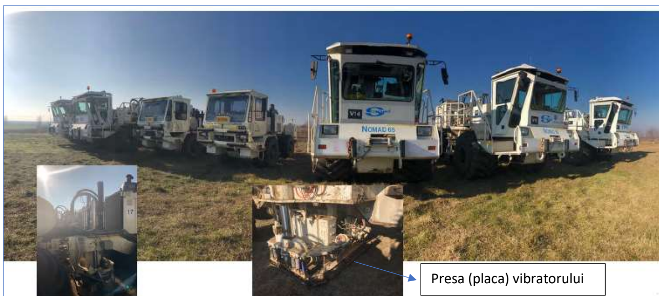
Fig. 12 Vehicul de tip Vibroseis (sursa foto: HOCOR SRL)
