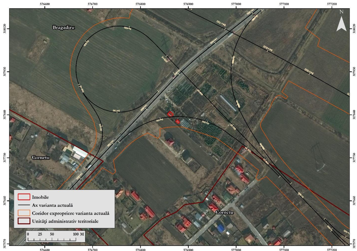
Figura nr. 3-6 Imobile ce trebuie demolate pentru realizarea nodului rutier
