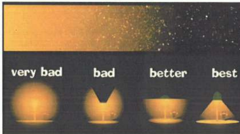
Figura nr. 5-1 Exemplu al unui sistem de iluminare adecvat pentru concentrarea dispersiei exclusiv asupra căii ferate sau obiectivului de interes (ex: peroane, gări)
