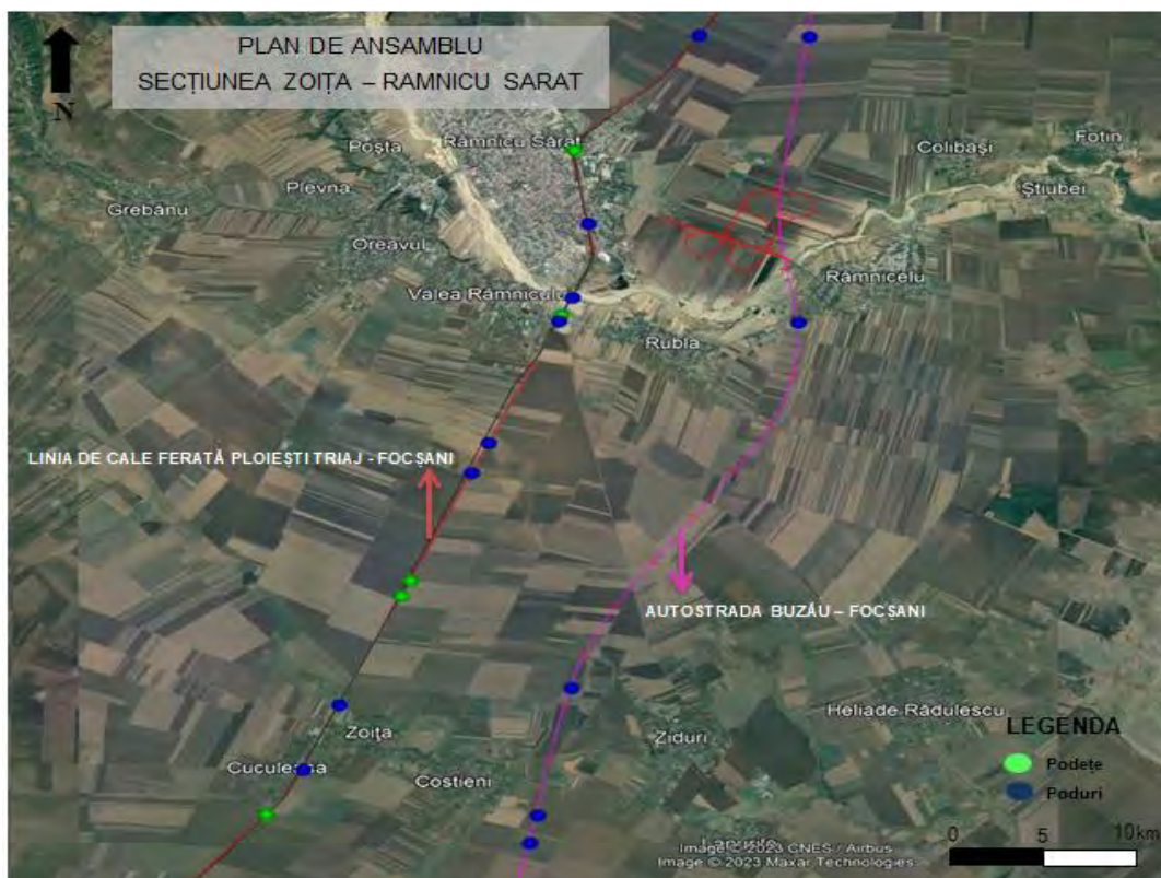
Figura - Permeabilitatea zonei – proiectul de reabilitare a liniei CF în relație cu structurile autostrăzii A7
