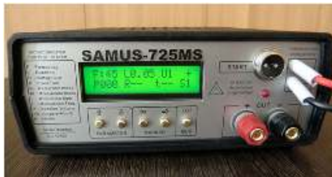
Foto 74. Aparatul de electronarcoză Samus 725 MS utilizat pentru pescuitul științific
