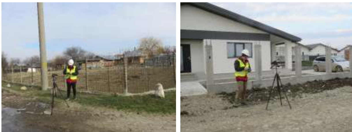
Foto 6.4. Măsurarea nivelului de zgomot
