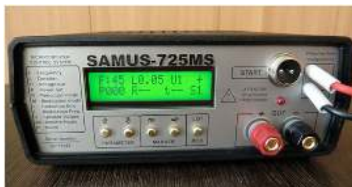
Foto 6.8. Aparatul de electronarcoză Samus 725 MS utilizat pentru pescuitul științific
