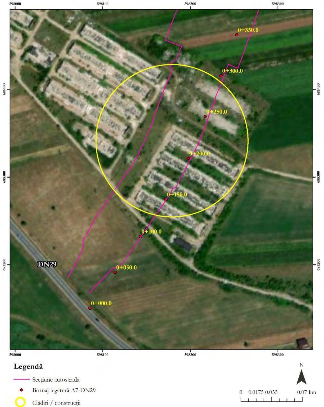
Figura nr. 2-14 Construcții propuse pentru demolări în zona km 0+100 – km 0+300 al autostrăzii Pașcani - Suceava
