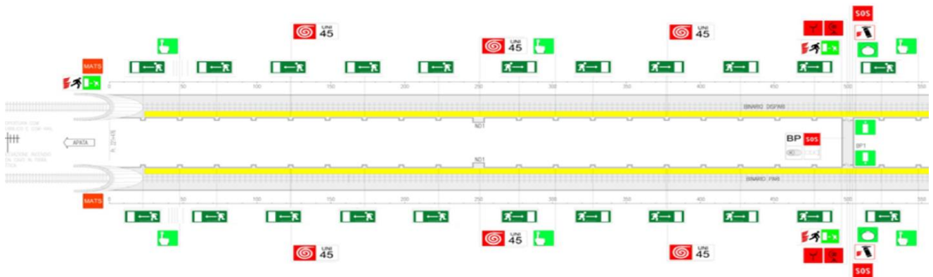
Figura 11. Semnalizarea pentru evacuarea în caz de urgență
