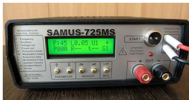
Foto 139. Aparatul de electronarcoză Samus 725 MS utilizat pentru pescuitul științific
