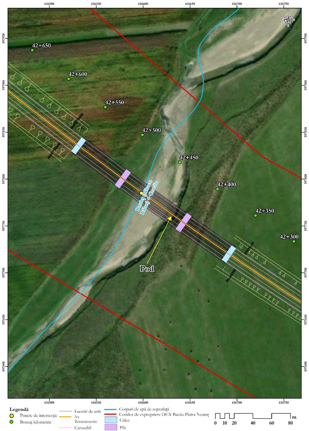
Figura nr. 2-11 Pod proiectat pe corpul de apă Bouleț (Mitocu Bălan) + Cracău (RORW12-1-53-60_B1)
