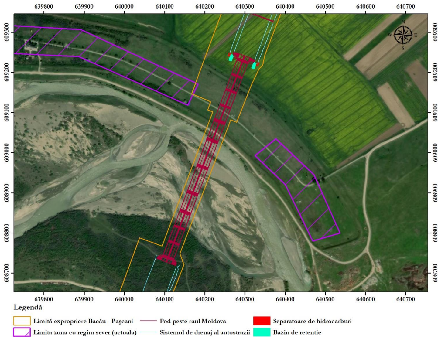
Figura nr. 9-2 Măsură de evitare a evacuării apelor pluviale în zona de protecție sanitară cu regim sever aferentă frontului de captare Pildești-Simionești prin prevederea a două bazine de retenție la km 40+000
