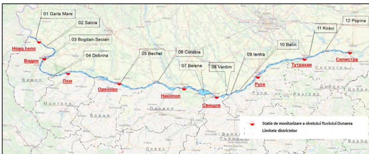
Figura 4.4-3 Amplasarea statiilor hidrometrice pe malul bulgar al Dunarii intre km 863 si km 375
