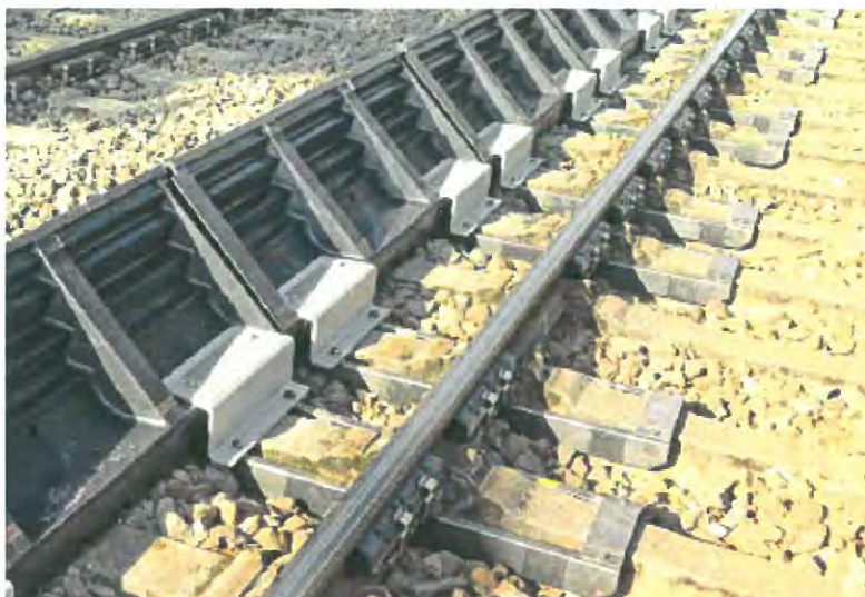
Figura nr. 3-3 Exemplu de sistem de protecție împotriva zgomotului montat pe traversă
