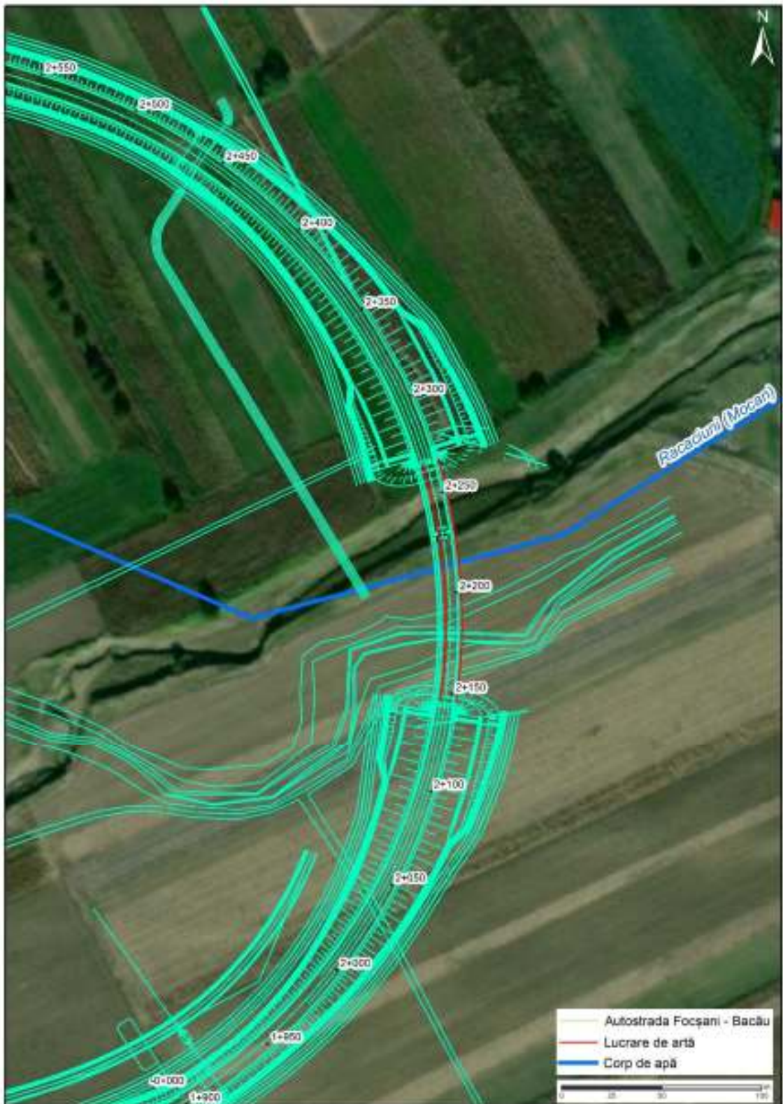
Figura 28. Pod pe bretea peste corpul de apă de suprafață RORW12.1.60_B1 Răcăciuni (pe bretea)
