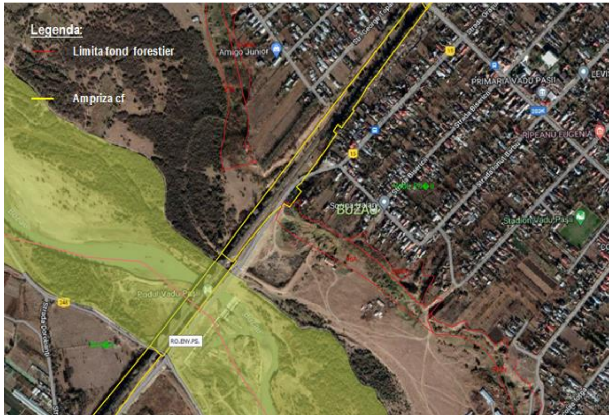
Figura 11 – Suprapunere ampriza lucrărilor cu suprafețe din fondul forestier național pe teritoriul UAT Valea Pașii, jud. Buzău
