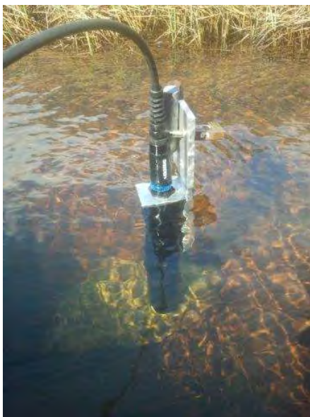
Figura nr. 5-2 Sistem de monitorizare a calității apei utilizând sonde multiparametrice
