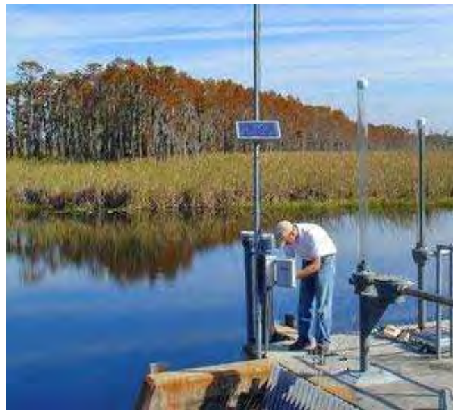
Figura nr. 5-2 Sistem de monitorizare a calității apei utilizând sonde multiparametrice
