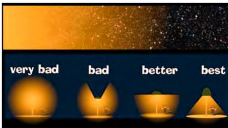
Figura nr. 5-1 Exemplu al unui sistem de iluminare adecvat pentru concentrarea dispersiei exclusiv asupra căii ferate (sursa: Rieswijk, 2014)
