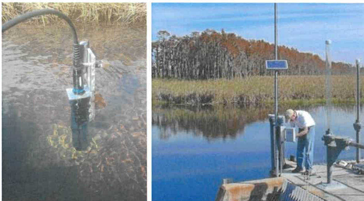
Figura nr. 5-2 Sistem de monitorizare a calității apei utilizând sonde multiparametrice
