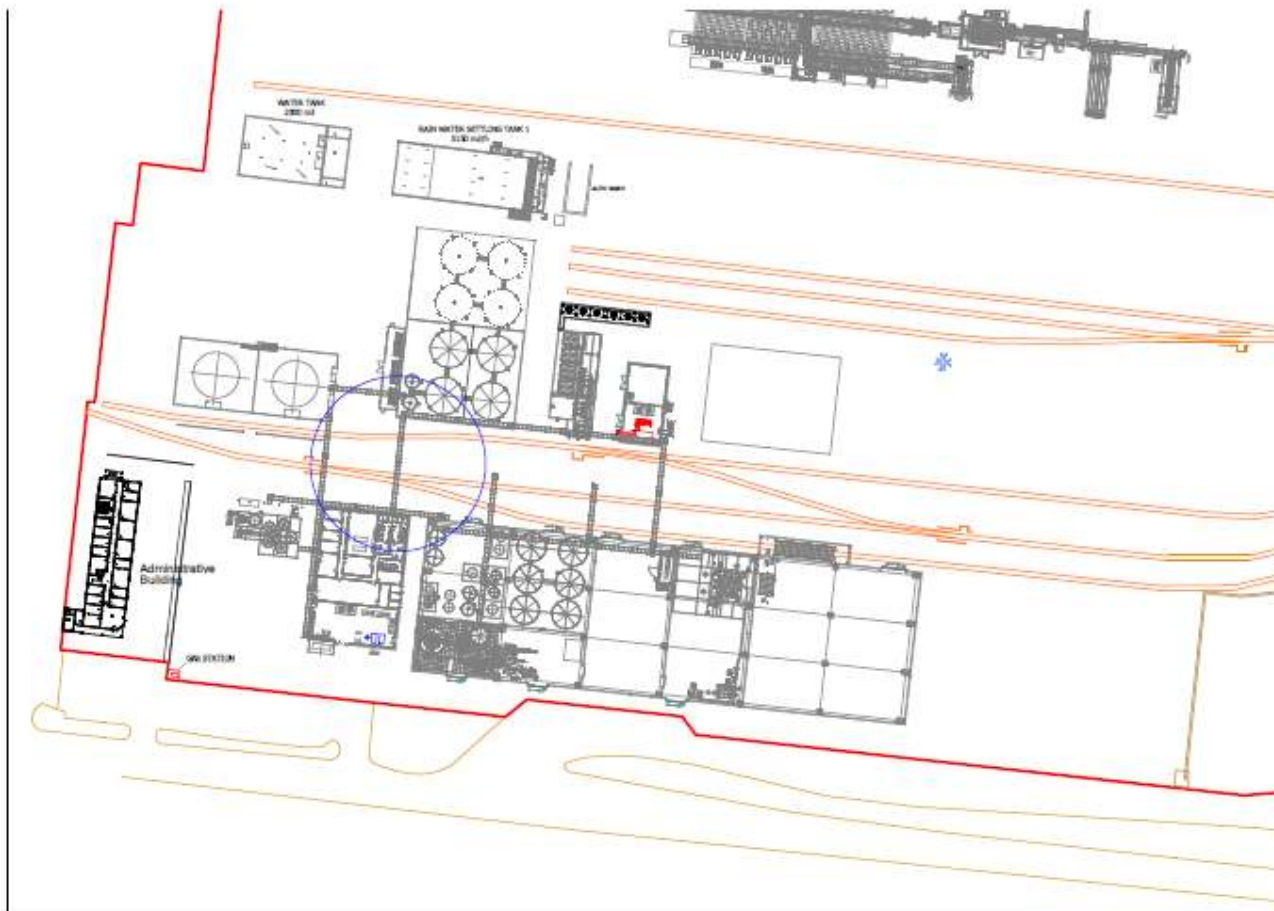
Figura 33 Scenariul 6.b. - Avariarea unei conducte de formaldehida de la rezervoare la instalatia de fabricare rasini. Conditii de raspandire medii
