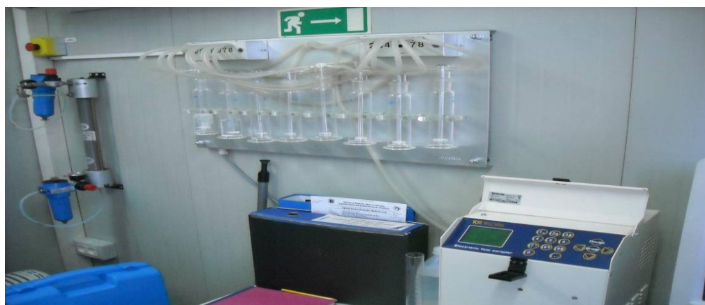
Figura nr. I.1.1.1.9 – Sistem de prelevare formaldehidă – AB2- Sebeș
