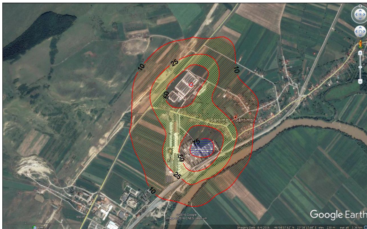
Figura 6: Concentratii maxime de amoniac in aer – timp de mediere 24 ore (fermele 3 si 4 Santimbru)
