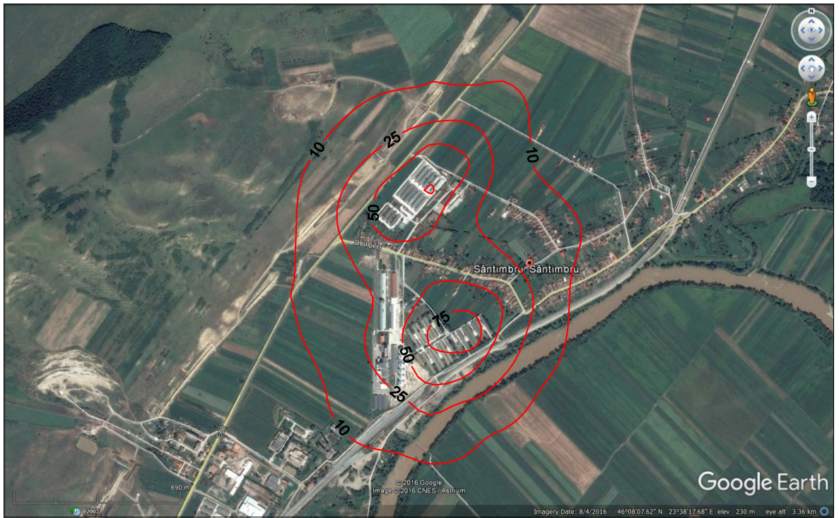
Figura 4: Concentratii maxime de amoniac in aer – timp de mediere 24 ore (fermele 3 si 4 Santimbru)
