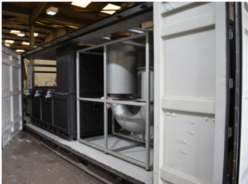
Figură 10 - Scrubber Venturi
