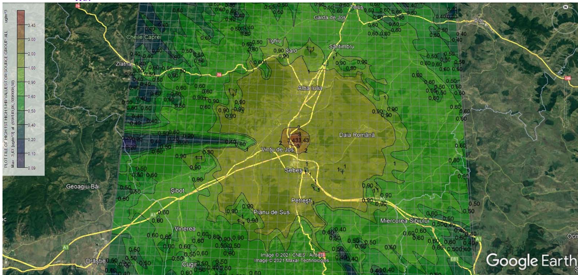
Figură 48: modelarea dispersiei HCl – perioadă de mediere 30 minute
