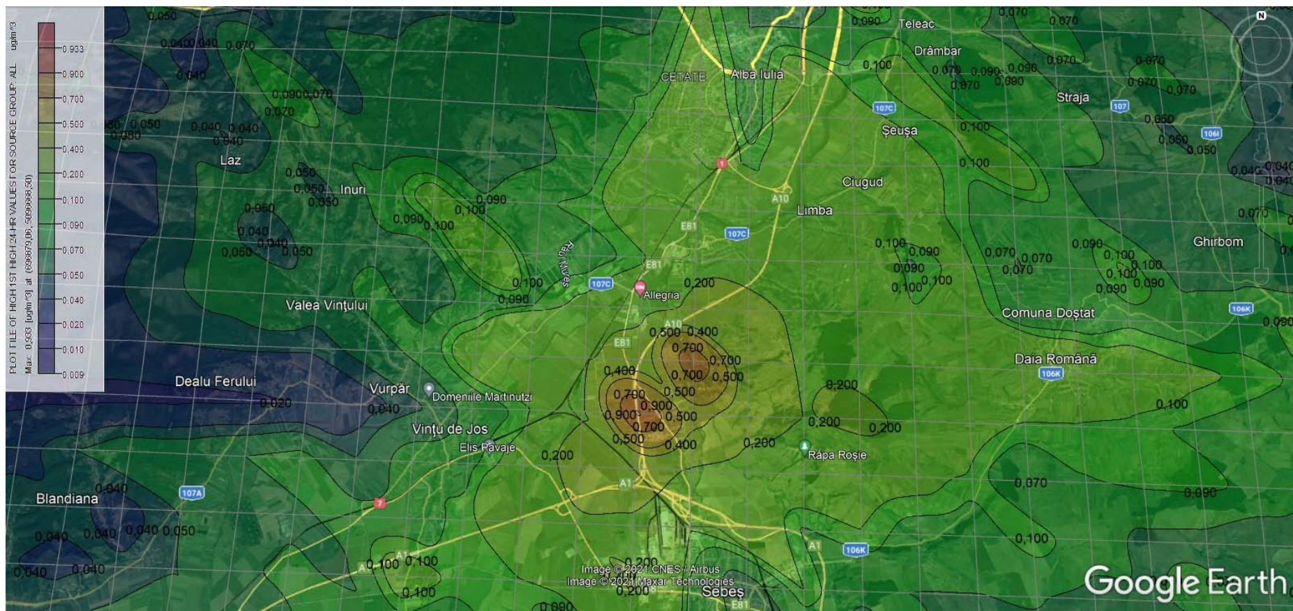
Figură 51: modelarea dispersiei HCl – perioadă de mediere 24 h – detaliu
