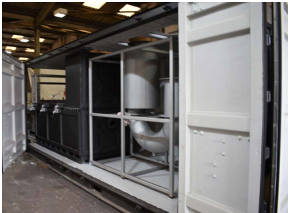
Figură 11 - Scrubber Venturi
