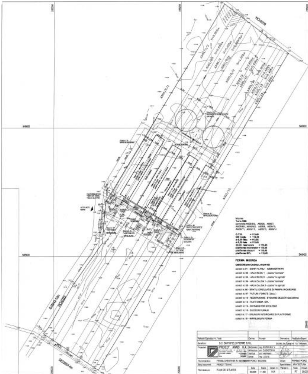
Figura 4: Plan de amplasament cu traseele rețelilor de canalizare
