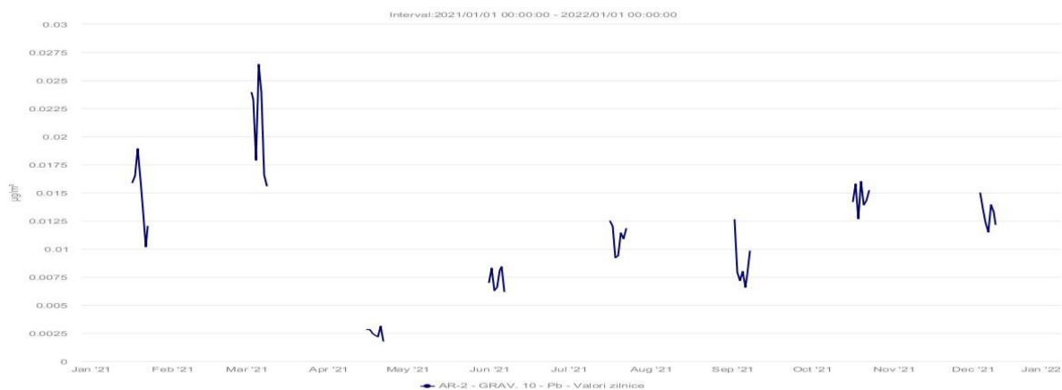
Figura nr. I.1.1.1.3.2. Evoluția valorii limită anuale de Pb ( \mu\text{g}/\text{mc} ) din PM 10 gravimetric în anul 2021, la Stația automată de monitorizare AR2
