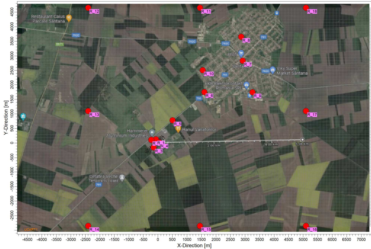
Figura 14: Discretizarea domeniului de interes, amplasarea rețelei uniforme de receptori (pas 50 metri și amplasarea receptorilor predefiniți folosiți (punct roșu) pentru studiul impactului asupra mediului (Model Actual și Viitor)
