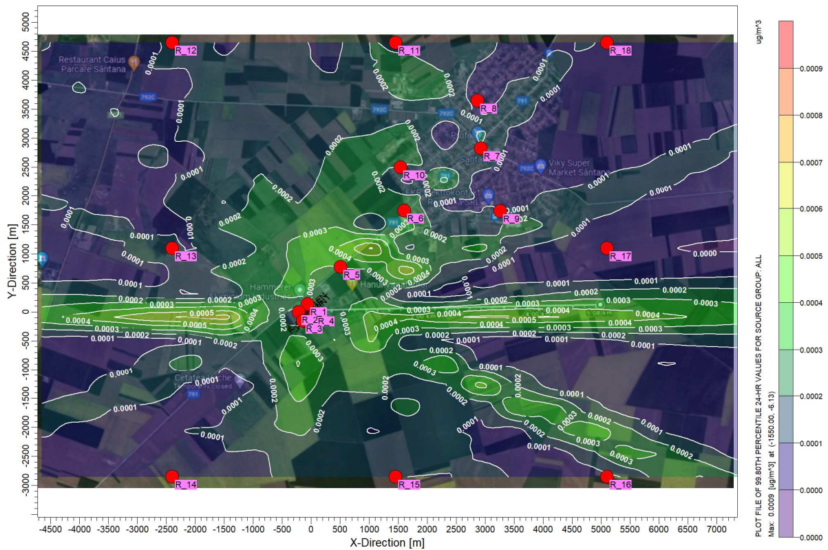
Figura 49. Harta dispersiei rezultata conform modelarii numerice (specia Cupru (Cu)) medie 24 ore situatia viitoare.
