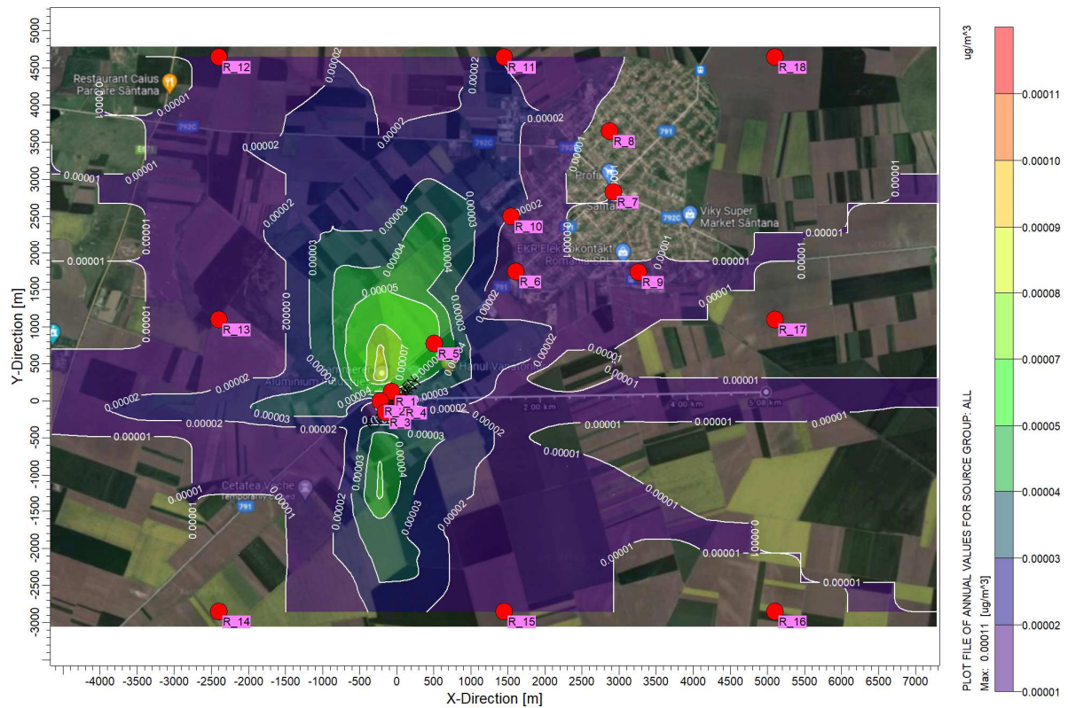
Figura 53. Harta dispersiei rezultata conform modelarii numerice (specia Nichel (Ni)) medie anuala situatia viitoare.
