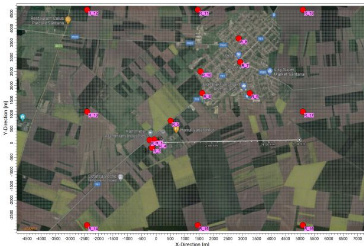
Figura 14: Discretizarea domeniului de interes, amplasarea rețelei uniforme de receptori (pas 50 metri si amplasarea receptorilor predefiniti folositi (punct rosu) pentru studiul impactului asupra mediului (Model Actual si Viitor)
