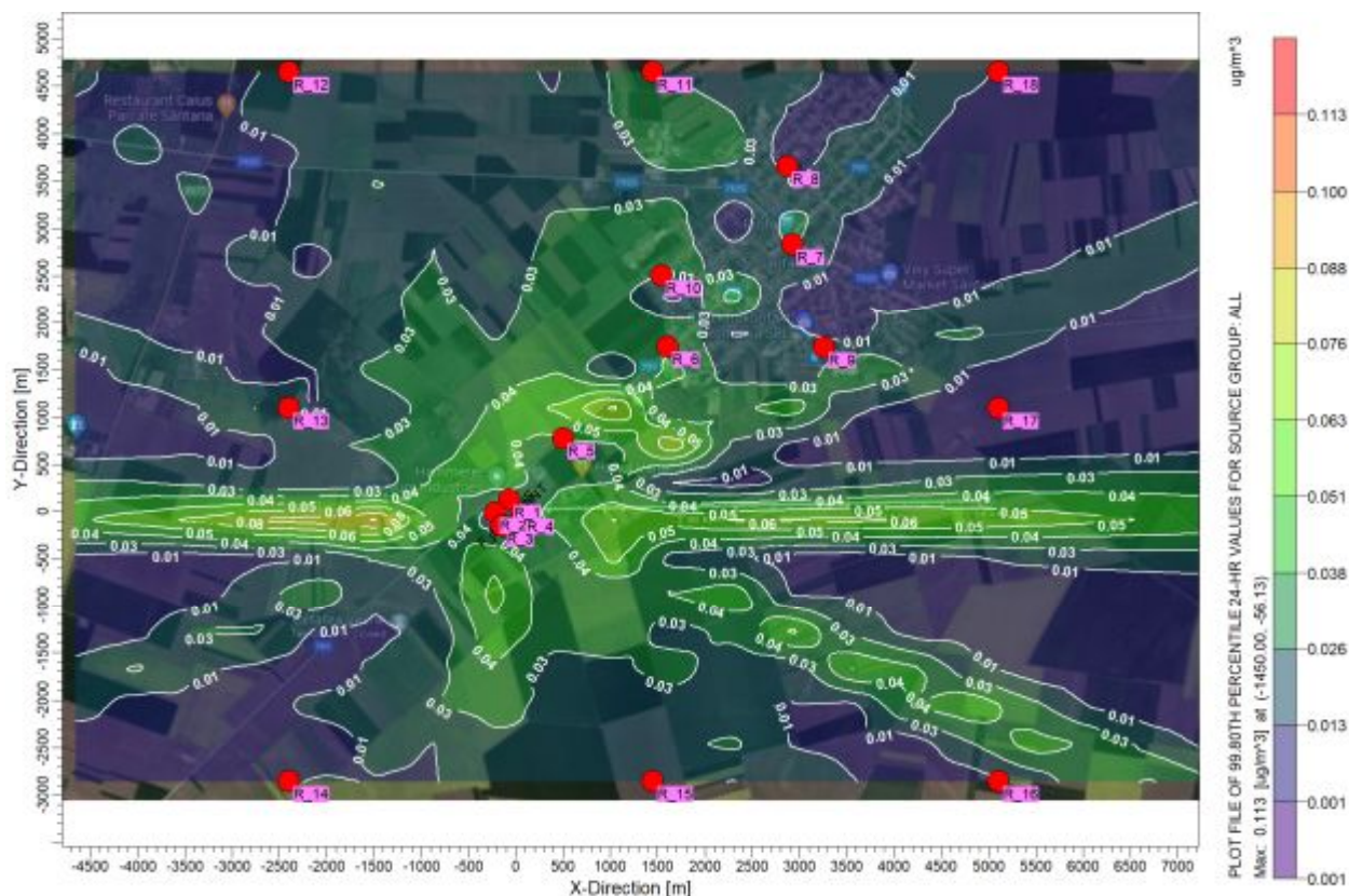
Figura 61. Harta dispersiei rezultata conform modelarii numerice (specia Benzen (C6H6)) medie 24 ore situatia viitoare.
