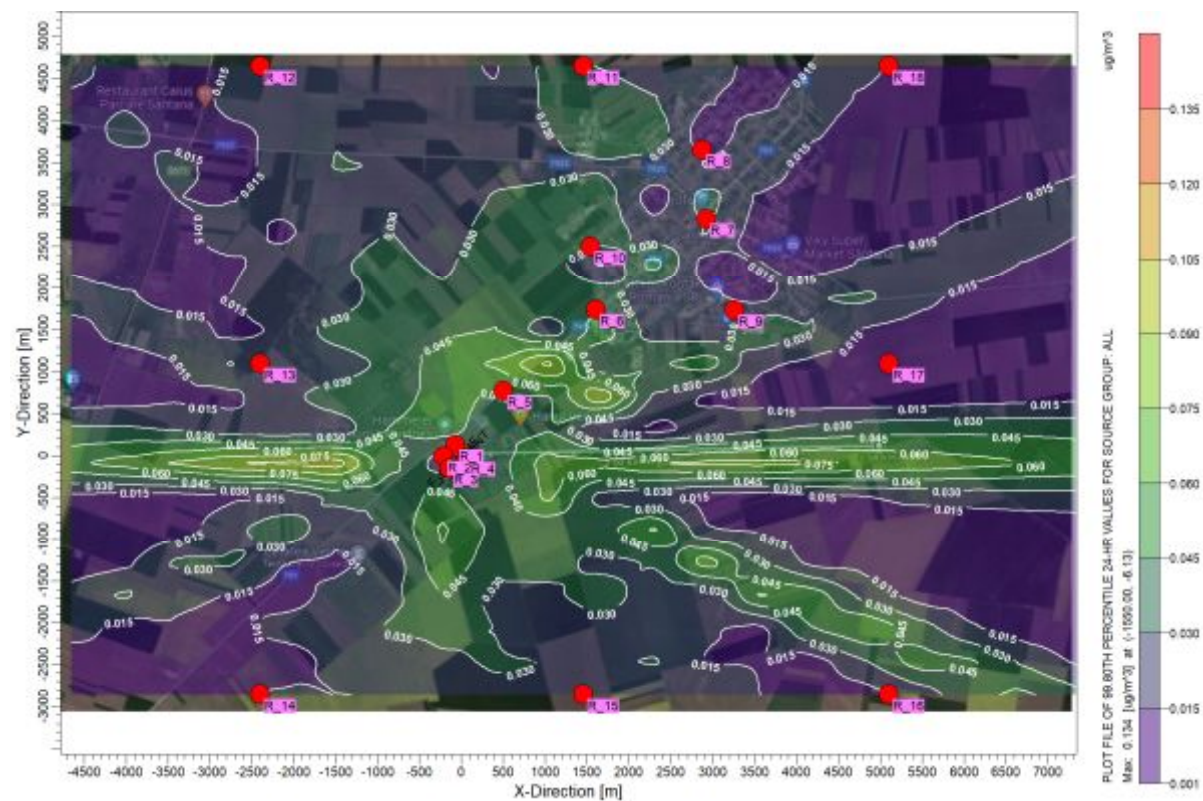
Figura 66. Harta dispersiei rezultata conform modelarii numerice (specia Hexaclorbenzen) medie 24 ore situatia actuala.
