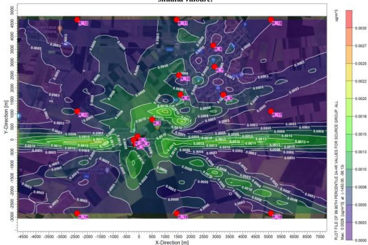
Figura 32. Harta dispersiei rezultata conform modelarii numerice (Floruri exprimate ca (HF)) medie 24 ore situatia actuala.
