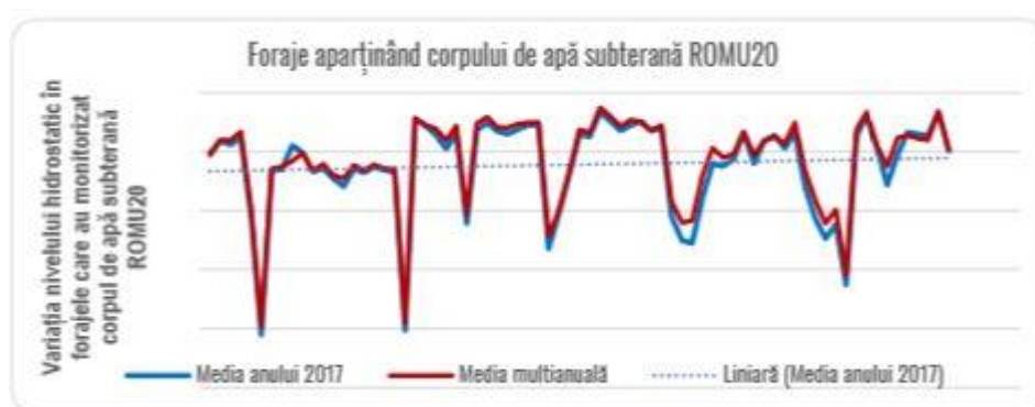
Fig.4. Evoluția mediei nivelurilor hidrostatice multianuale și a mediei anuale pentru 2017 pentru corpul de apă subterană ROMU20
