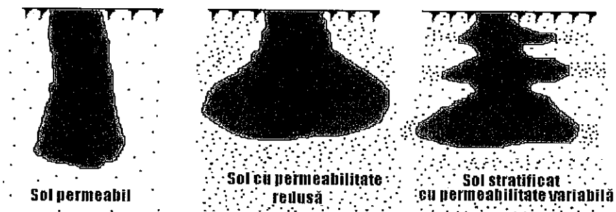
Figura 11 – Forme ale corpului de impregnare pentru diferite permeabilități ale solului
