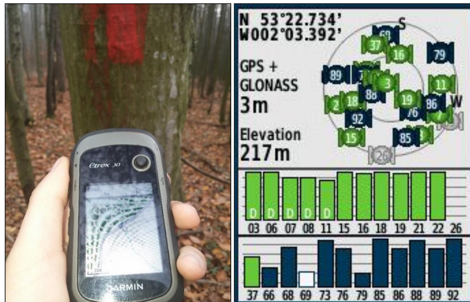
Figura 2.3.2.-3 Receptorul GPS folosit, precizia și numărul de sateliți
